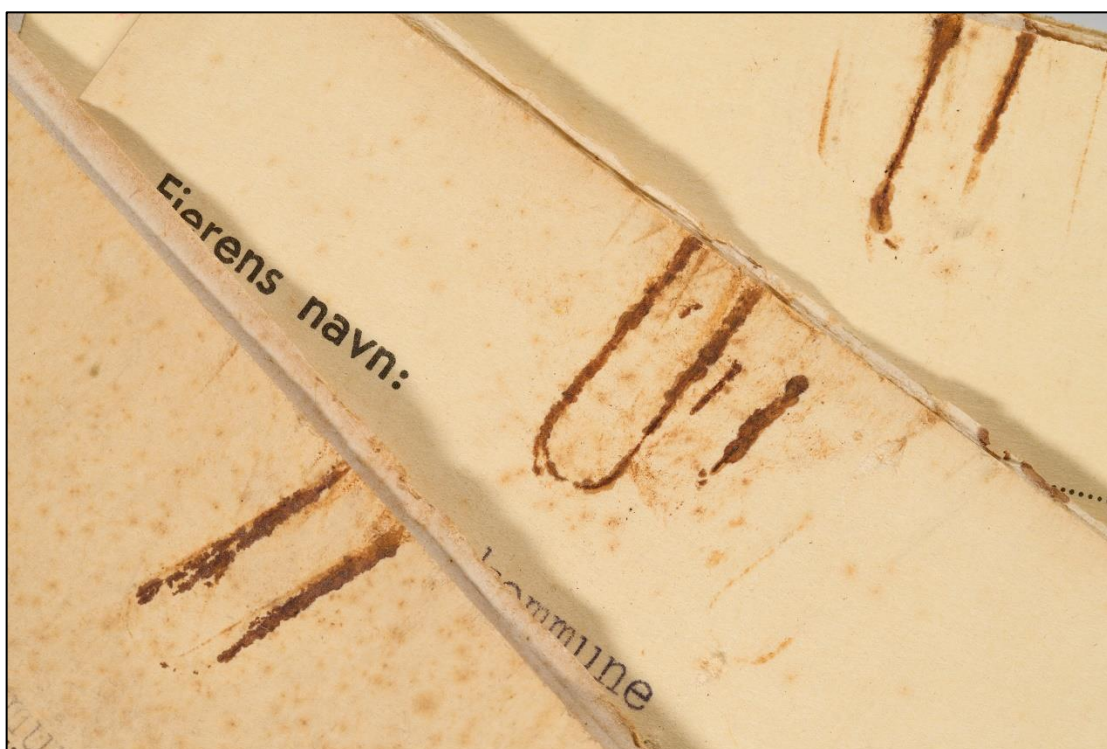
Figur 3: Alt metall skal ryddast vekk frå arkiva. Når binders og andre metallobjekt kjem i kontakt med fukt rustar dei og rusten set seg fast i papiret. Dette kan vere særskadeleg for arkiva. Berre moderne stiftar kan få stå (1990-talet og seinare), av praktiske grunnar, og fordi dei ikkje reagerer så kraftig på fukt. Foto: Piotr Cabaj, SEDAK
