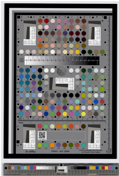
// Image Science Associates (ISA) referanse korta/«targets» FADGI 19264 Device level target og object level target. Foto: Piotr Cabaj / IKAMR //
